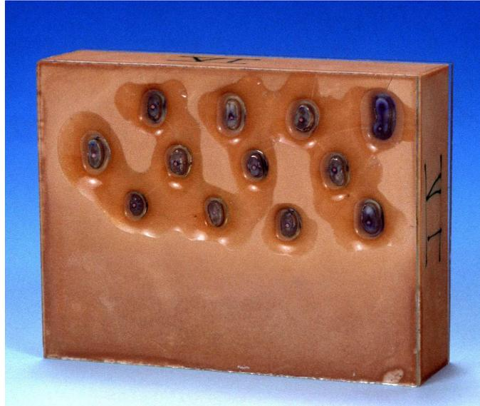
Abb. 7: Epoxidharzblock mit eingebetten Proben
