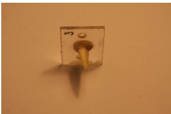
*Abb. 12: Zahn in Plexiglasträger einpolymerisiert*
