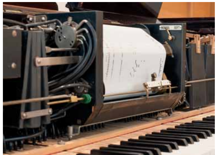
Elektro-pneumatischer Flügel, Steck/Aeolion, Detail Unterdruckschläuche, Klavierrolle, Saugbälge; Foto: Deutsche Nationalbibliothek / Stephan Jockel
