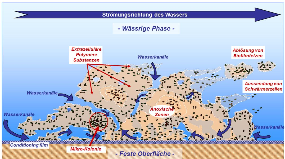
**Abbildung 3:** Schematische Darstellung der heterogenen Biofilmstruktur, welche geprägt ist durch in die EPS eingebettete Mikrokolonien von Mikroorganismen und einem komplexen Netz an Wasserkanälen.
