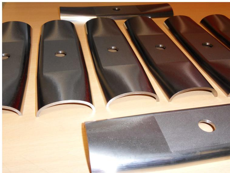
**Abbildung 9.1:** *Oben:* Fertigung der vier Tankwannen. *Unten:* Produktion der geraden Stützenkomponenten (Eigentum Research Instruments).
