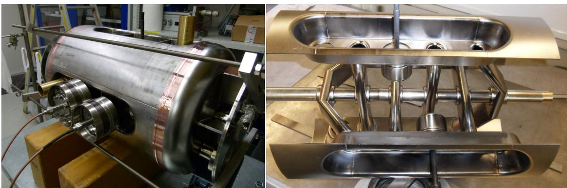
Abbildung 4.4: *Links:* Bestückung der Kavität mit verschiebbaren Messingtunern. *Rechts:* Ansicht aus der Fertigung mit eingeschweißten Balgtunern.
