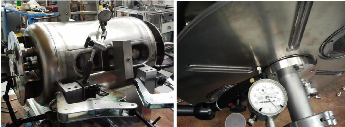
**Abbildung 4.9:** *Links:* Messaufbau zur Bestimmung der Deformation beim Abpumpvorgang. Die Messuhren wurden an einem zentralen Punkt am Mantelsegment sowie an den beiden Enddeckeln angebracht.
