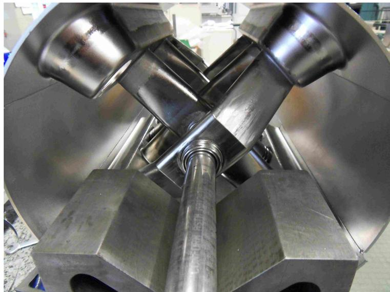
**Abbildung 9.2:** *Oben:* Produktion der Balgtunerkomponenten. *Unten:* Zusammenbau der inneren Resonatorstruktur mit Mantelsegmenten (Eigentum Research Instruments).
