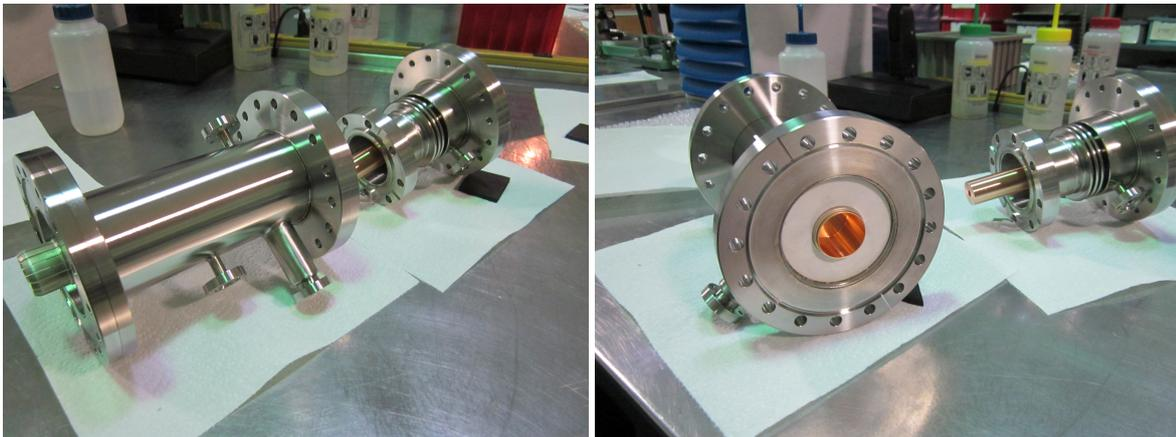
**Abbildung 7.6:** Bilder der produzierten Kopplerteile. Im Vordergrund: Warmes Fenster mit Pumpflansch und zwei Diagnoseflanschen. Im Hintergrund: Kaltes Fenster mit Diagnoseflansch und verlängerbarem Innenleiter (Eigentum Omley Industries, Inc.).
