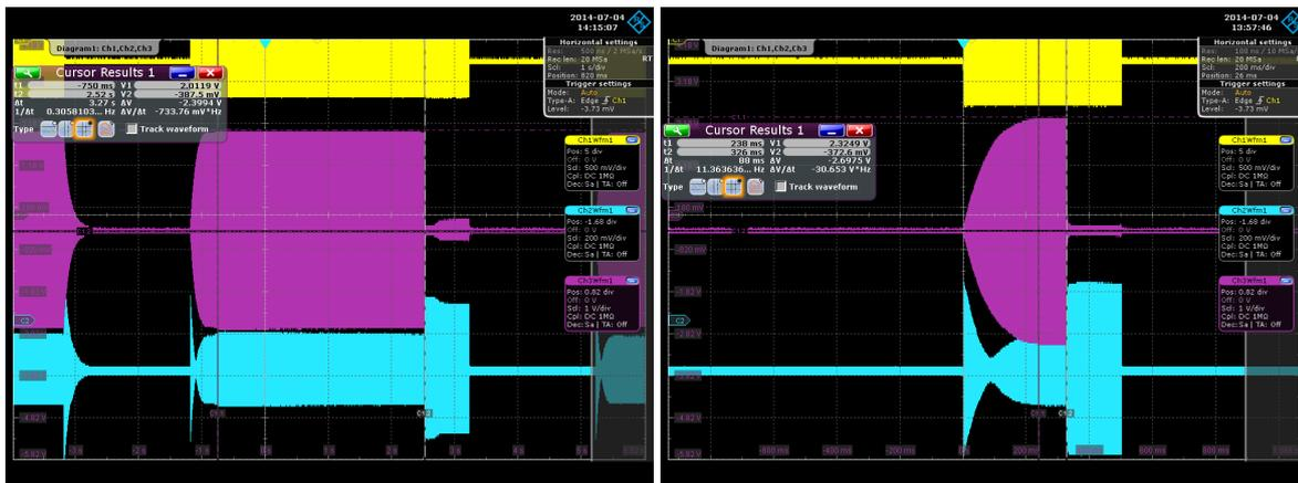
**Abbildung 5.22:** Bestimmung des Gradienten im gepulsten Betrieb. *Links:* Bei einer Pick-up Spannung von 2.3994 V ( $\rightarrow E_a=8.54 \text{ MV/m}$ ) ist das Signal für 3.27 s stabil. *Rechts:* Für eine Spannung von 2.6975 V ( $\rightarrow E_a=9.72 \text{ MV/m}$ ) kann das Feld für 88 ms aufrecht erhalten werden.
