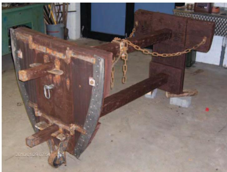
Abbildung 3.2: Spülwagen für Eiprofil  $DN\ 1800/1200\ mm$  (Foto: Hansewasser Ver- und Entsorgung-GmbH).
