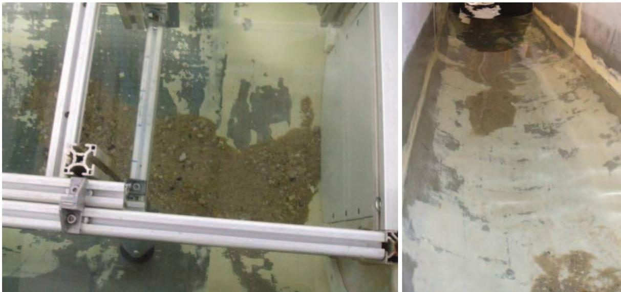
Abbildung 5.39: Ergebnis eines Modellversuches mit „überspülter“ Stauwand: große Mengen an Modellsediment wurden zurückgelassen infolge der Überfahrt des Stauwagens.
