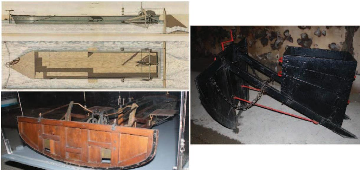
Abbildung 2.17: Oben - Arbeitsprinzip eines Spülkanus (aus *Sewerhistory* 2013). Unten - Historisches Spülkanu der Pariser Kanalisation. Rechts - Historischer Spülschlitten der Pariser Kanalisation.
