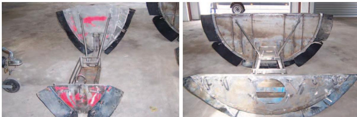
Abbildung 3.7: Links - Stauwagen für Eiprofil  $DN\ 1000/1500\ mm$  (variabel). Rechts - Stauwagen für Maulprofil  $DN\ 1330/2000\ mm$  (Fotos: Städtische Werke Magdeburg GmbH).
