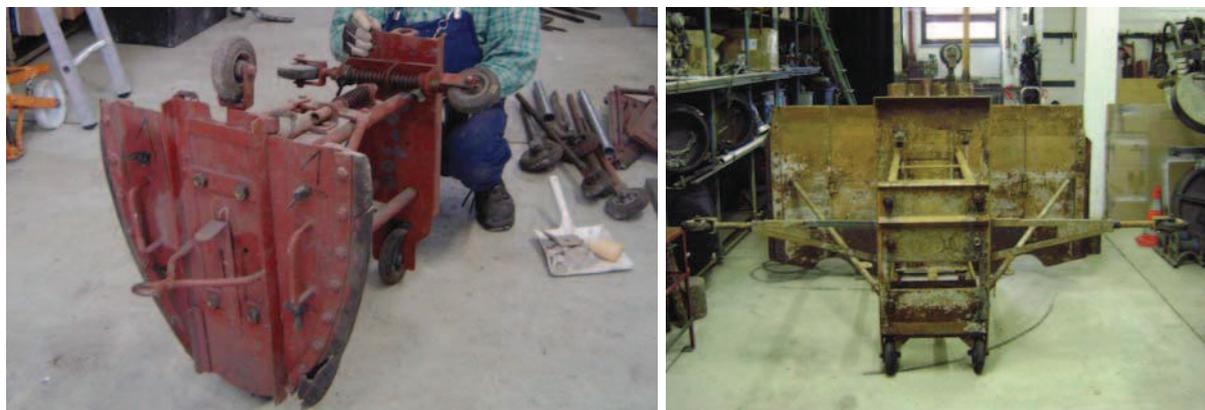
Abbildung 3.1: Links - Spülapparat für Eiprofil  $DN\ 1300/900\ mm$ . Rechts - Spülapparat für Maulprofil  $DN\ 2200/2000\ mm$  (Foto: Berliner Kanalnetz).
