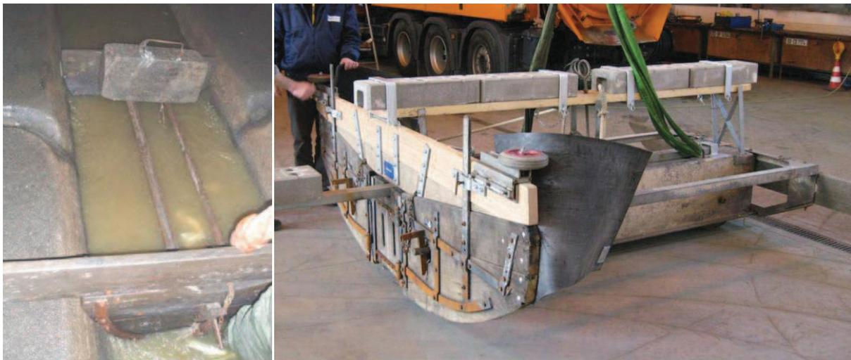
Abbildung 3.3: Links - „Kleiner Spülwagen“ für Haubenprofil  $DN\ 2000\ mm$ . Rechts - „Großer Spülwagen“ für Maulprofil  $DN\ 3200/3060\ mm$ .
