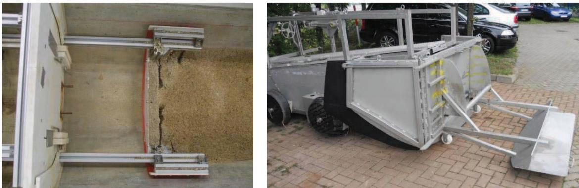
Abbildung 7.7: Abstandshalter / Räumschieber, angebracht am Modellwagen (links) und am Pilotwagen (rechts).
