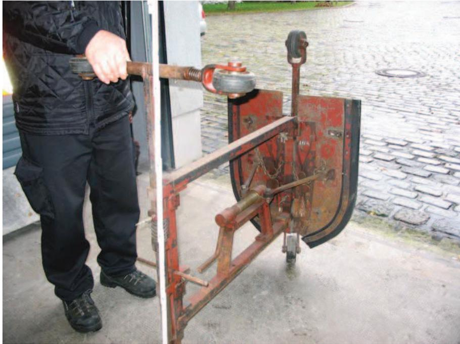
Abbildung 3.9: „Hunt“ für den Einsatz im Eiprofil  $DN\ 1200/1800\ mm$  (Foto: Stadtentwässerung München).
