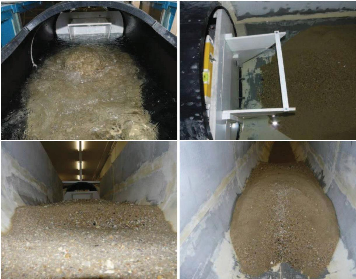
Abbildung 5.20: Stauwagen während des Reinigungsbetriebes (links oben) und nach einem Versuchsdurchlauf (rechts oben). Erzielte Sedimentdüne nach einem Versuchsdurchlauf (unten).
