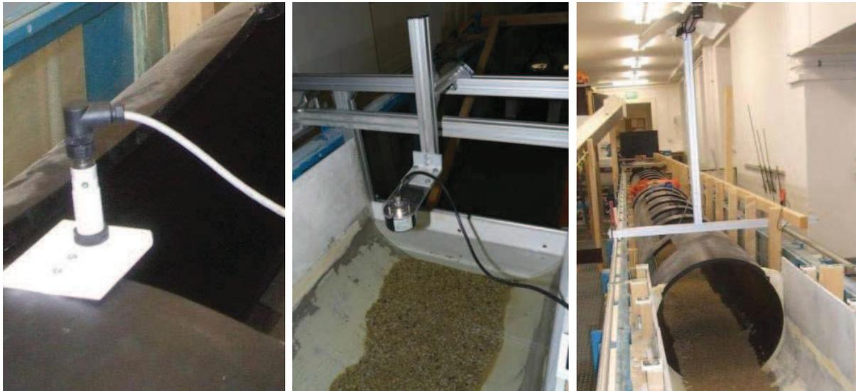
Abbildung 5.18: Ultraschallmessung für die Erfassung der Aufstauhöhe (links) und für die Rückstauhöhe (Mitte). Festinstallierte *WEB-CAM* zur Überwachung des Reinigungsprozesses (rechts).
