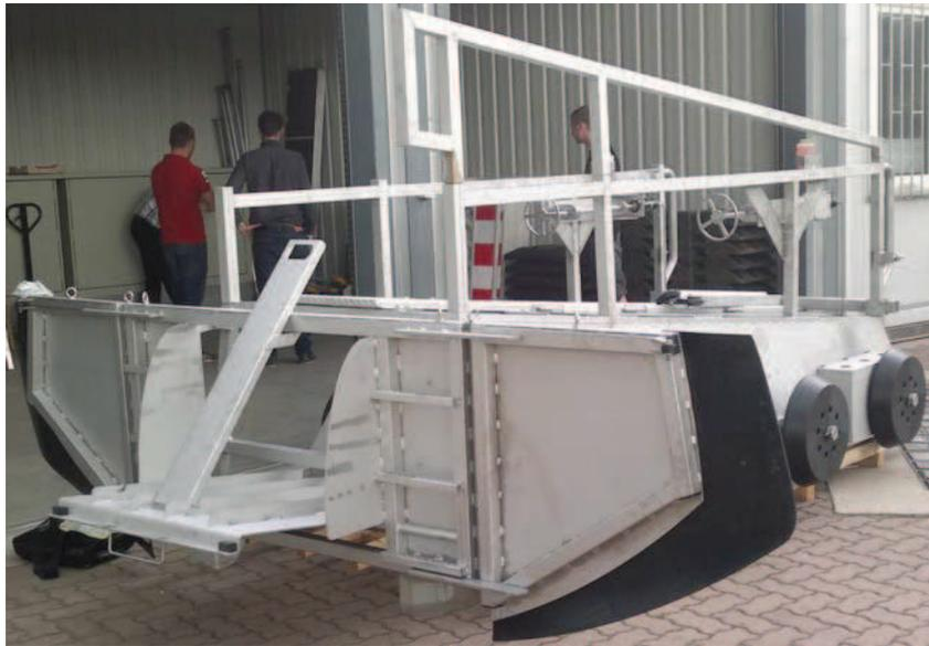
Abbildung 7.1: Forschungsmuster für die Reinigung des „Altstädter Abfangkanals“, mit dem die Naturversuche durchgeführt wurden.
