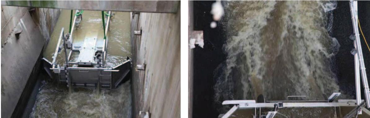
Abbildung 7.2: Links: erste Einstau - Dichtigkeitsprüfung des Schildes und Kanal-anpassung. Rechts: Strömungsverhältnisse in unmittelbarer Nähe des Stauschildes bei einem Einstau von etwa 105 cm.
