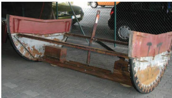
Abbildung 3.5: Stauwagen für den Einsatz im DN 2000 *mm* (Foto: Tiefbauamt der Stadt Karlsruhe).
