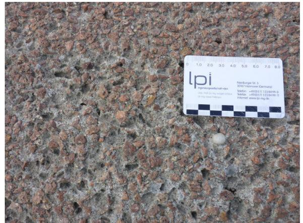
Bild 5.33: Erprobungsstrecke CEM III/A-S (2). Oberfläche im November 2014
