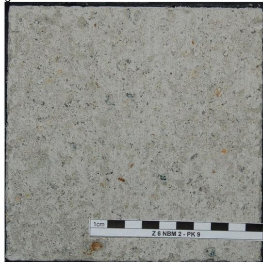
Bild 4.22: CEM III/A (19,9) 20/65 NBM2opti. Betonoberfläche nach 28 FTW, Abwitterungsmenge 500 g/m<sup>2</sup>.
