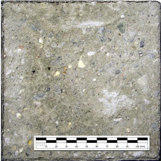
Bild 4.19: CEM II/B-S (16,8) 20/65 oNB. Betonoberfläche nach 28 FTW, Abwitterungsmenge 2130 g/m<sup>2</sup>.
