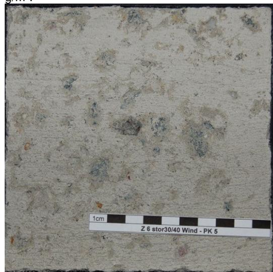
Bild 4.24: CEM III/A (19,9) 30/40 mW. Betonoberfläche nach 28 FTW, Abwitterungsmenge 540 g/m<sup>2</sup>.
