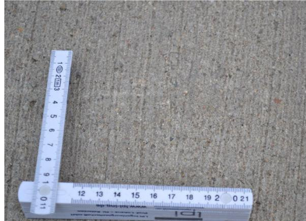
Bild 5.23: Erprobungsstrecke CEM II/A-S (1). Oberfläche im Juli 2014.
