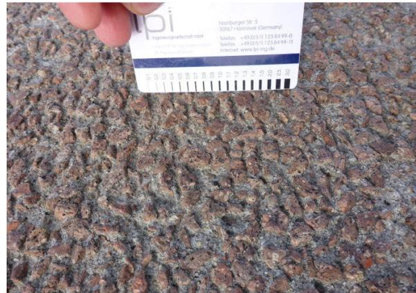
Bild 5.31: Erprobungsstrecke CEM III/A-S (2). Oberfläche im November 2014
