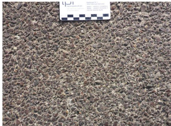
Bild 5.27: Erprobungsstrecke CEM III/A-S (1). Oberfläche im November 2014.
