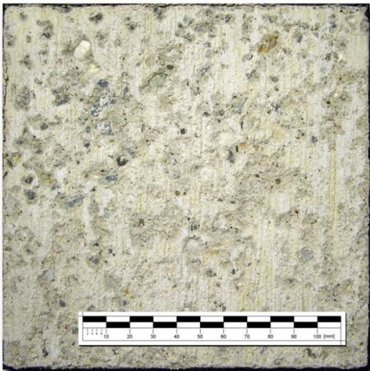
Bild 4.21: CEM II/B-S (16,8) 20/65 5dfeucht. Betonoberfläche nach 28 FTW, Abwitterungsmenge 500 g/m<sup>2</sup>.
