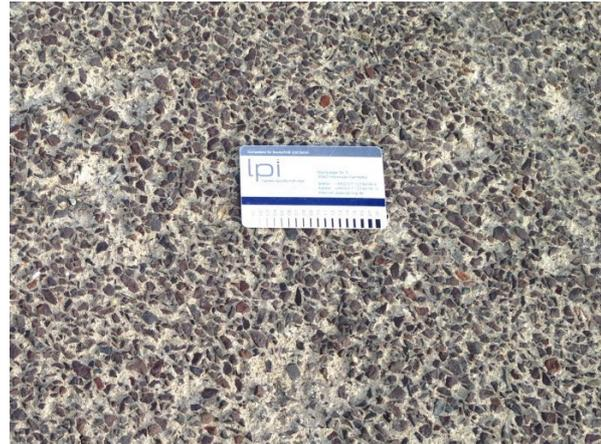
Bild 5.29: Erprobungsstrecke CEM III/A-S (1). Oberfläche im November 2014.
