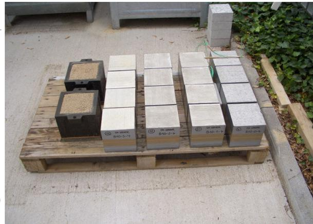
Bild 5.2: Beispiel für eine Probenlagerung. Die beiden links stehenden, mit feuchtem Sand gefüllten Proben dienen zur Aufnahme der Verdunstungsbedingungen.
