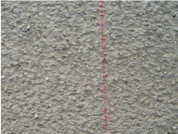
Bild 5.28: Erprobungsstrecke CEM III/A-S (1). Oberfläche im Oktober 2007.
