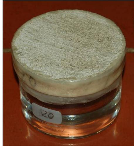
Bild 7.9: Wet-cup zur Bestimmung des Wasserdampfdiffusionswiderstandes.
