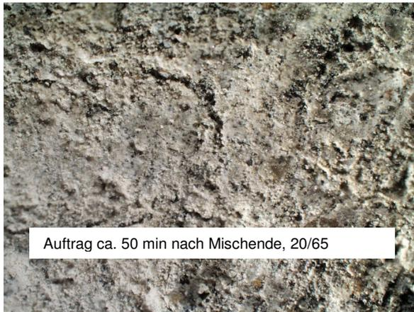
Bild 3.41: NBM-Auftrag 10 min nach Besenstrich (ca. 50 min nach Mischende). Da sich kein geschlossener Wachsfilm ausbildet, ergibt sich keine Sperrwirkung. Horizontale Bildweite 6,8 mm.
