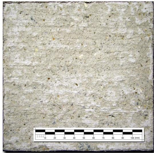
Bild 4.20: CEM II/B-S (16,8) 20/65 NBM1opti. Betonoberfläche nach 28 FTW, Abwitterungsmenge 900 g/m<sup>2</sup>.
