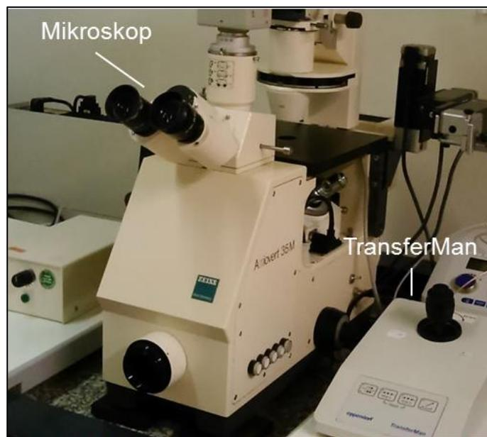
**Abb. 16:** Mikroskop für die Mikroinjektion in parthenogenetische porcine Embryonen.
