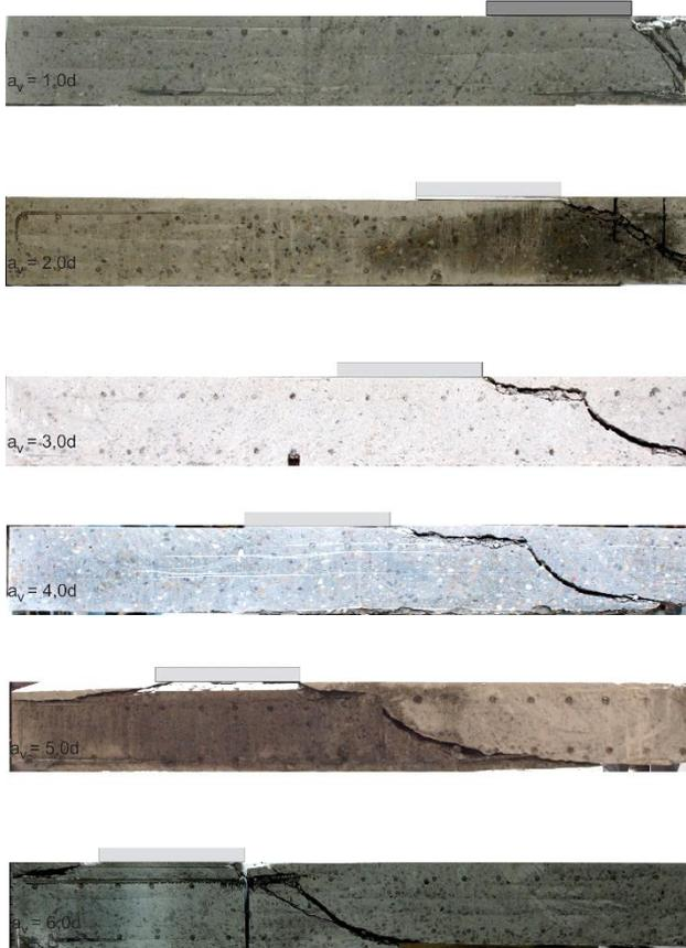
Bild 5-6: Sägeschnitte der Versuche mit einer Einzellast in Richtung des Hauptlastabtrags durch die Lasteinleitung
