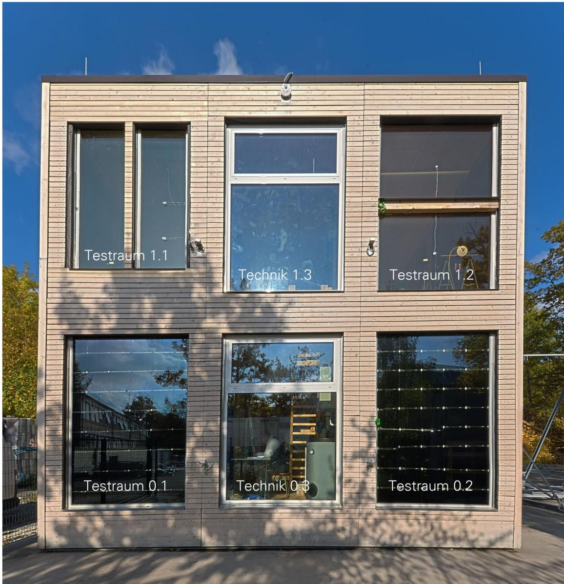
Abbildung 4-1: Südfassade des Fassadenprüfstands mit eingebauter TN-Verglasung des Typs 2 /  $i^3$  im Testraum 0.1 (sowie TN-Verglasung Typ 1 im Raum 0.2, elektrochrome Verglasungen in Räumen 1.1 und 1.2, statische Zweifach-Referenzverglasung in der Technikzone 0.3 und 1.3). Phot.: G. Metzger | ILEK.
