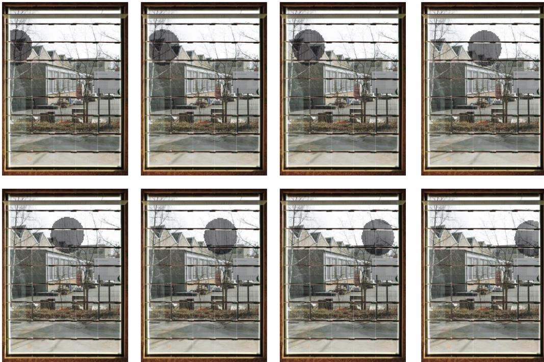
Abbildung 7-3: Unterteilung der Verglasungsfläche in zwei Funktionsbereiche. Aufnahmen aus dem Innenraum des Fassadentestgebäudes im Tagesverlauf. Phot.: G. Metzger, ILEK.
