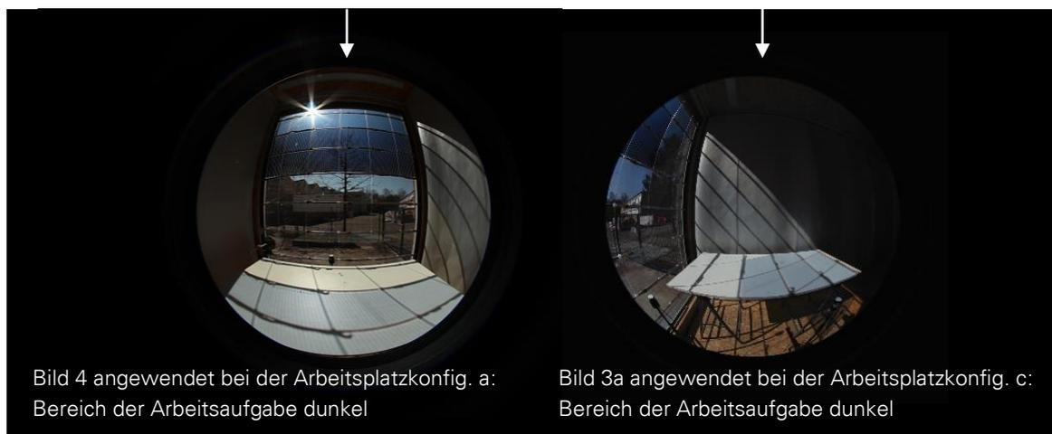
Abbildung 6-18: Angewendete Verschattungsmuster zur situationsbedingten Verschattung der Arbeitsaufgabe (schematische Darstellung)
