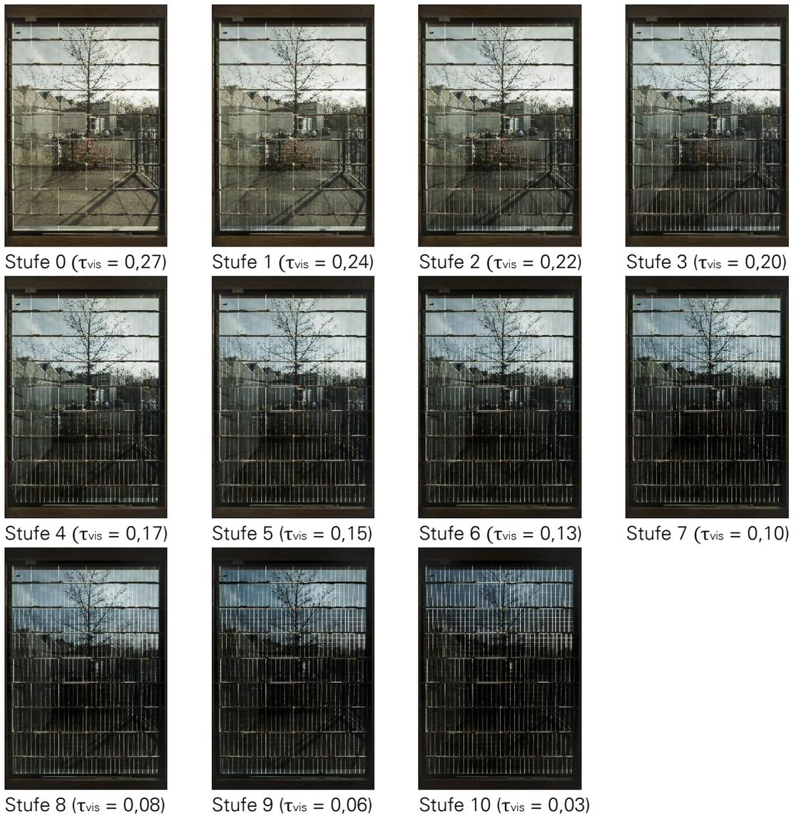
Abbildung 3-17: Fotodokumentation der Schaltzustände (Phot.: G. Metzger | ILEK)
