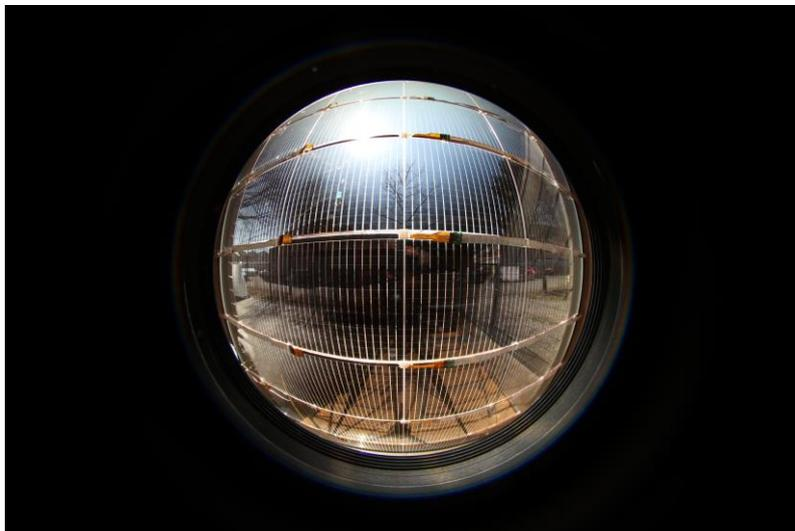
Abbildung 6-20: Nahaufnahme einer maximal abgedunkelten TN-Verglasung (<sup>i3</sup>) zur Darstellung der winkelabhängigen Transparenz (Zunahme der Durchsicht in Randbereichen)
