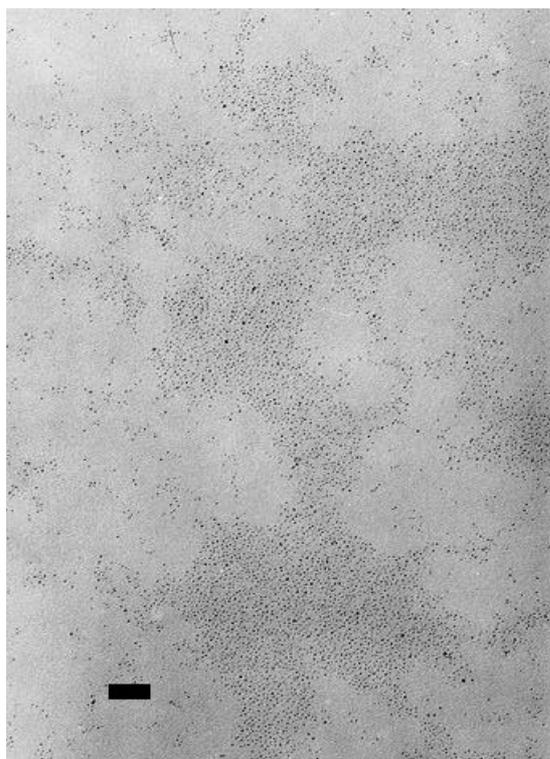
Abbildung 13.3.5: TEM-Aufnahme eines Pd/P(75%VP-co-25%VAL)-Sols (Balken: 50 nm)
