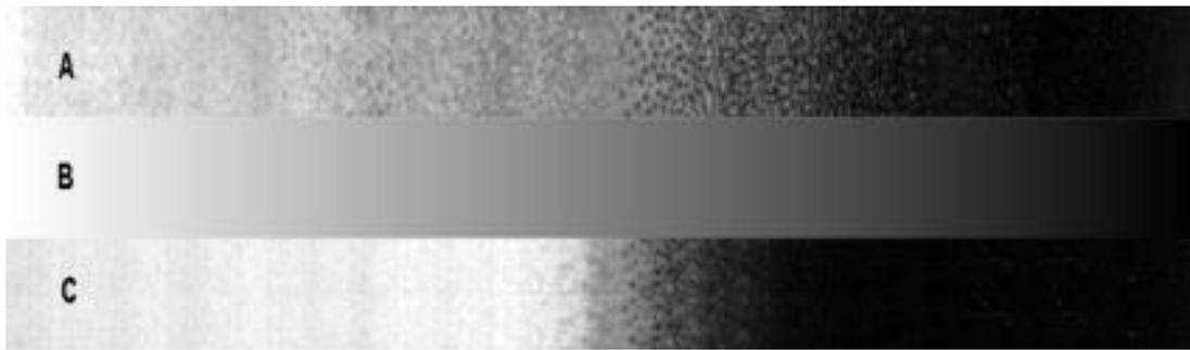
**Abbildung 4: Aufnahmen eines Graukeils zur Abschätzung der relativen Dynamik mit dem bloßen Auge.** Der mittlere Graukeil (B) diente als Vorlage zur Aufnahme durch beide Kameras. Er stellt eine lineare Abstufung von weiß nach Schwarz dar. Er hat einen  $\gamma$ -Koeffizienten von 1 und eine Dynamik von 256 Graustufen. Der obere Keil (A) ist mit der VarioCam aufgenommen worden, der untere (C) mit der Cybertech CS-1.
