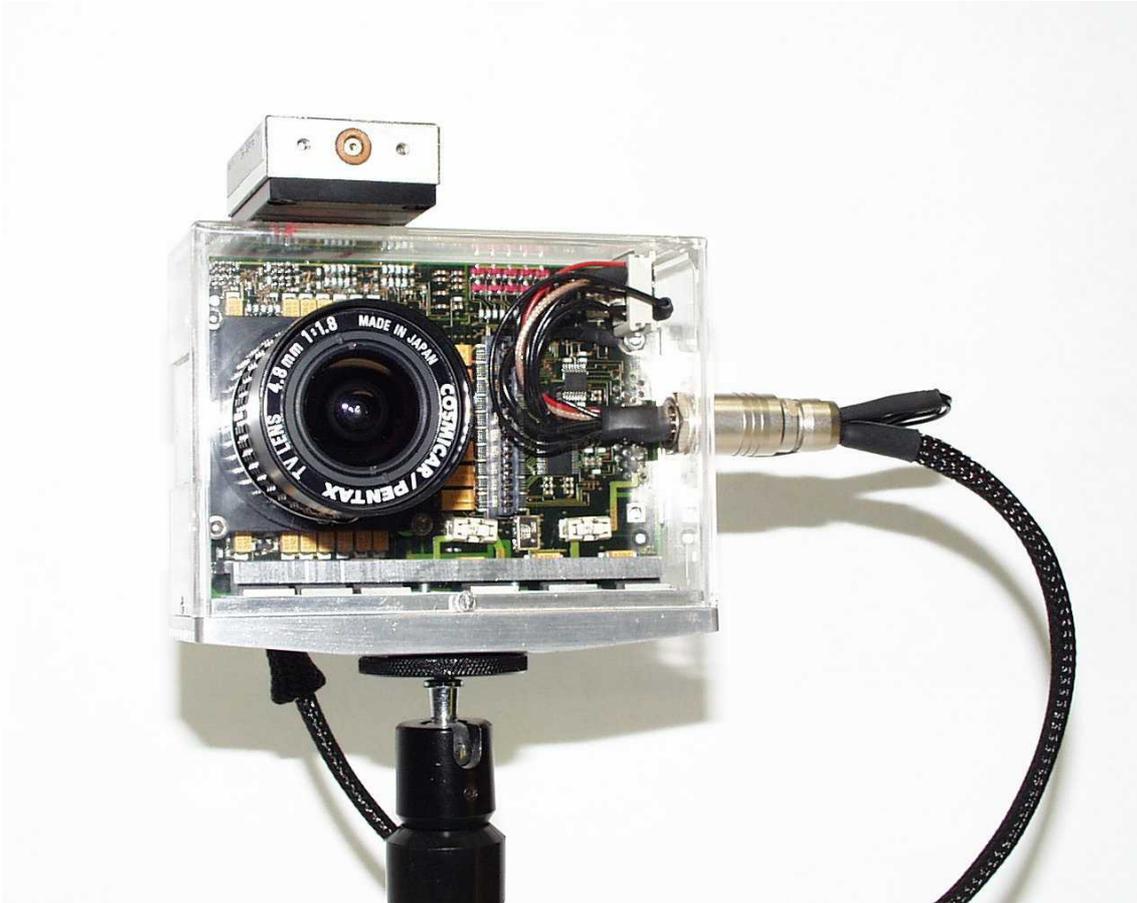
Abbildung 5.8: Tiefenkamerademonstrator
