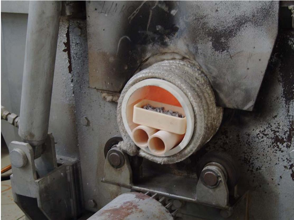
*Bild 4.1.-3: Probeschale vor dem Brennversuch*
