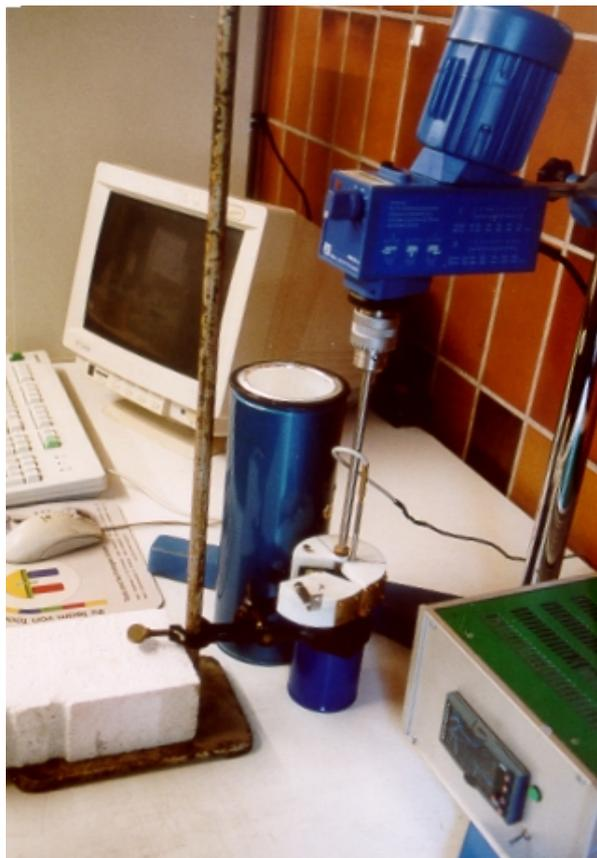
*Bild 5.1.1.1. – 1: Apparatur zur Bestimmung der Kalkreaktivität nach EN 459-2 und die Miniatur [Wolter 2002]*
