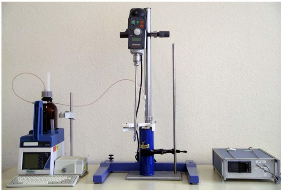
Bild 5.1.2.1-2: Apparatur zur Bestimmung der MgO-Reaktivität
