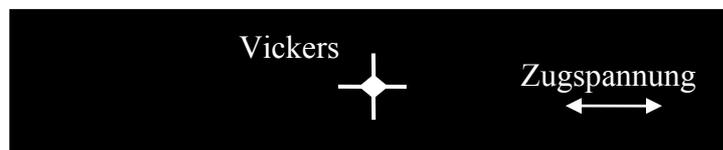
Abbildung 48: Lage des Vickersseindrucks in den Laborproben zur Bruchzähigkeitsbestimmung
