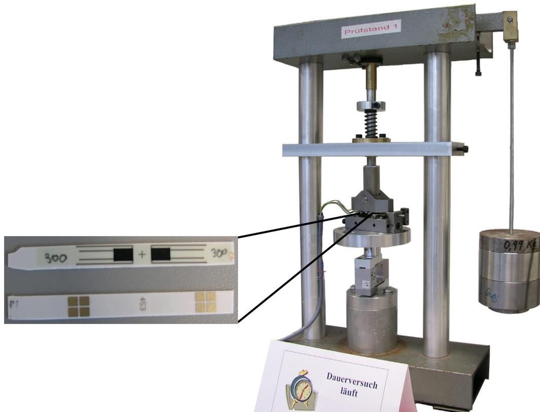
Abbildung 54: Ermüdungsprüfstand zur Bestimmung des unterkritischen Risswachstums. Ausschnitt: Proben mit elektrischer Kontaktierung für in-situ-Widerstandsmessungen.
