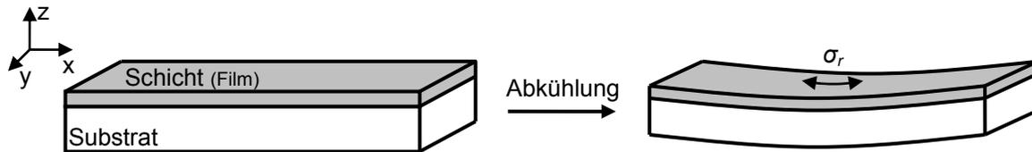
Abbildung 35: Messprinzip der Eigenspannungsbestimmung, die Eigenspannung in der Schicht führt zu einer Krümmung der Probe
