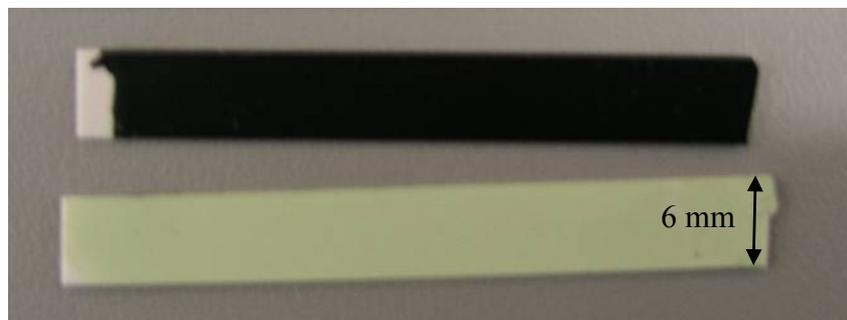
Abbildung 24: Exemplarische Abbildung der Laborproben (Blickrichtung von oben), das Abdeckglas ist grün (unten), der Widerstand ist schwarz (oben) und das Substrat ist weiß
