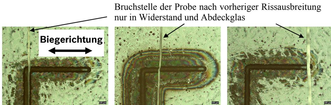
Abbildung 82: Lichtmikroskopische Aufnahmen des Laserschnittes mit Rissen an unterschiedlichen Positionen. Aus Darstellungsgründen werden vollständig gebrochene Proben gezeigt, links: Riss am Knick des Laserschnittes (häufig), Mitte: Riss an der geraden Kante des Laserschnittes (selten), rechts: Riss an der Spitze des Laserschnittes (häufig)
