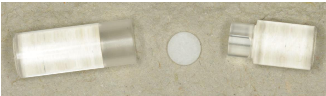
Abb. 3-5 TLD mit geöffneter PMMA-Schutzhülse.
