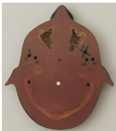
Abb. 3-3 RANDO® Kopfphantom. Axiale Ansicht der Level-4-Schicht in Höhe der Sinus maxillares mit Bohrlöchern für die TLD 7 bis 11.
