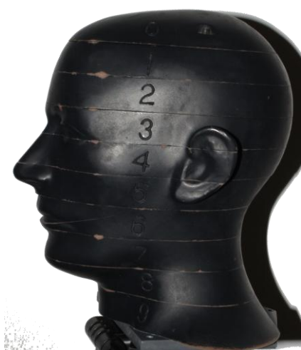
Abb. 3-2 RANDO® Kopfphantom. Laterale Ansicht mit Kennzeichnung der Level 1 bis 9.
