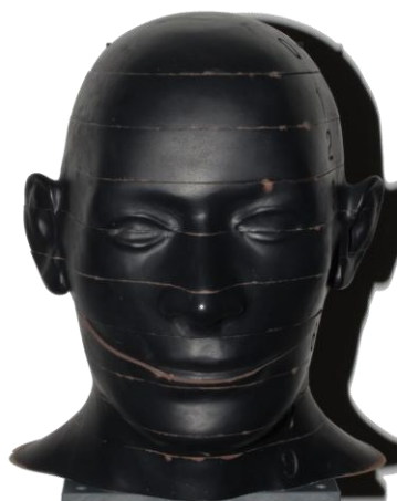
Abb. 3-1 RANDO® Kopfphantom. En face.
