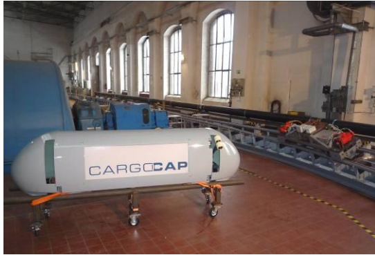
Abbildung 10: Verkleidetes Modellstreckenfahrzeug (links)
