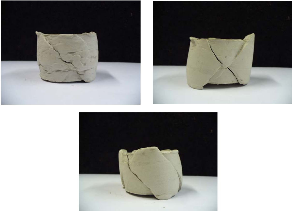
Abb.5.18: Fotos von im Triaxialversuch abgescheren Kaolinitproben (verschiedene Einbauparameter)
