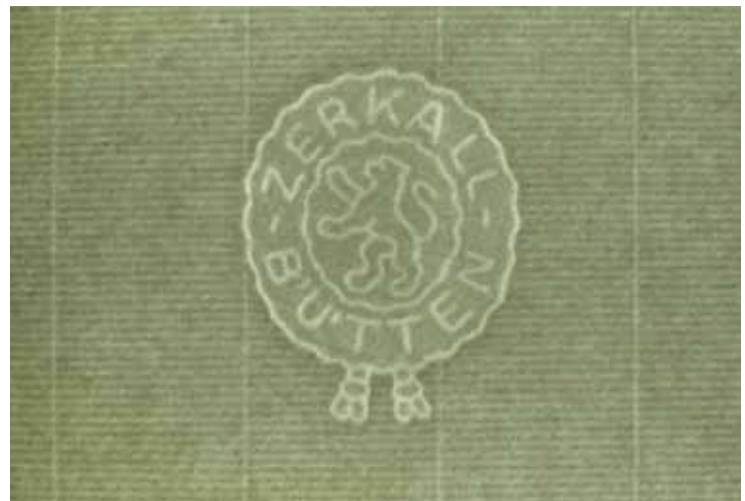
Auf der Rundsiebpapiermaschine hergestelltes geripptes Büttenpapier mit Wasserzeichen der Papierfabrik Zerkall Renker & Söhne GmbH & Co. KG, Hürtgenwald-Zerkall Foto: Deutsche Nationalbibliothek / Dr. Frieder Schmidt
