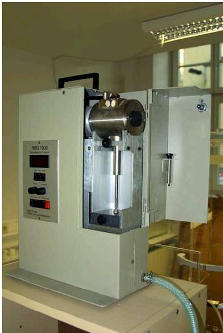
**Abbildung 10: Feststoffdispersierer Palas RBG 1000**
