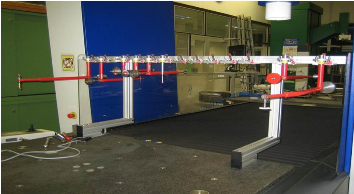
Abb. 2.21 Tasterbaumausstattung für Bauteil Kurbelgehäuse [12]
