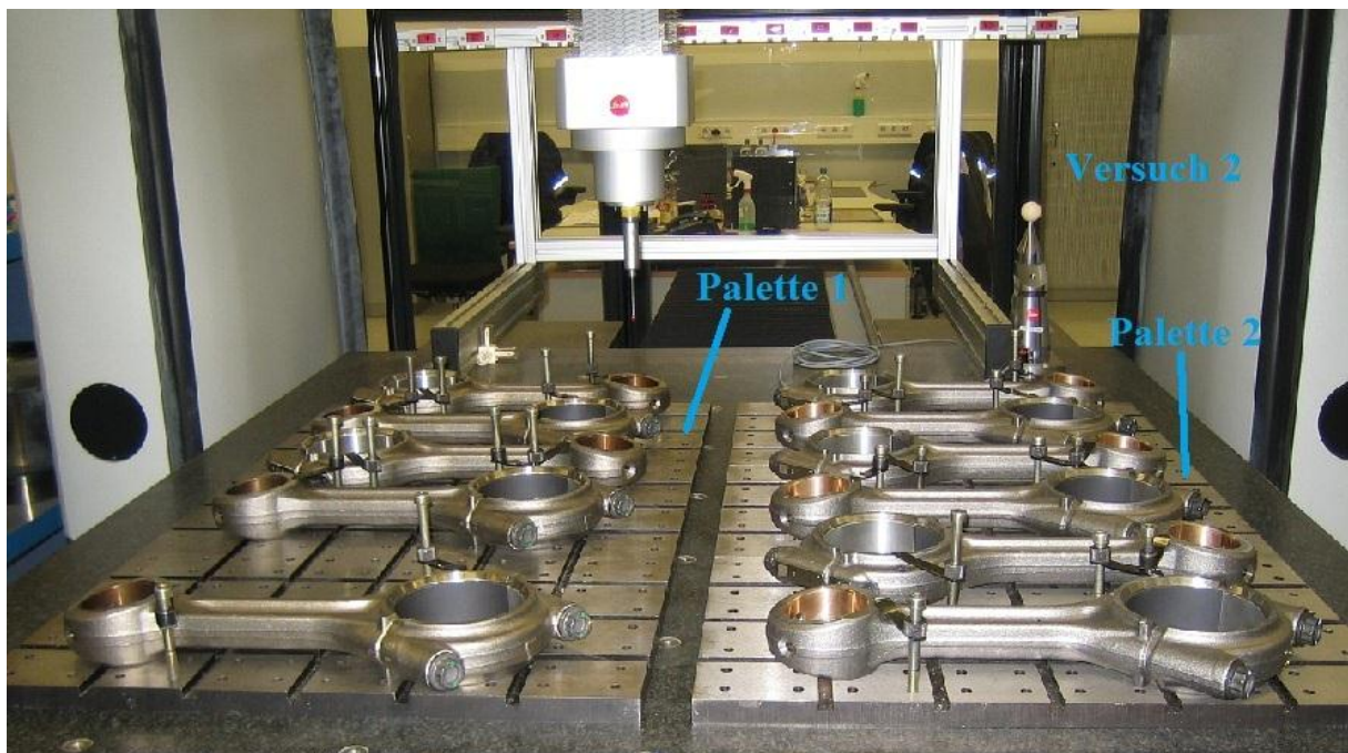
Abb. 4.7.a zwei Messpaletten einmal auf Messmaschine Aufspannung
