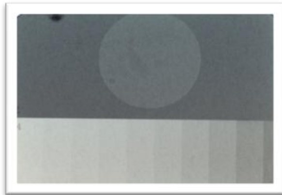
Abbildung 17 Zahnfilm mit Prüfkörper aus alkaliphosphatdotiertem Komposit (oben) und Aluminium- Stufentreppe (unten) mit ansteigender Dicke von rechts nach links
