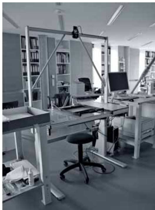
Die Kameraanlage mit höhenverstellbarer Arbeitsplatte und in festem Abstand montierter Kamera, rechts daneben, der Computer mit Monitor.
