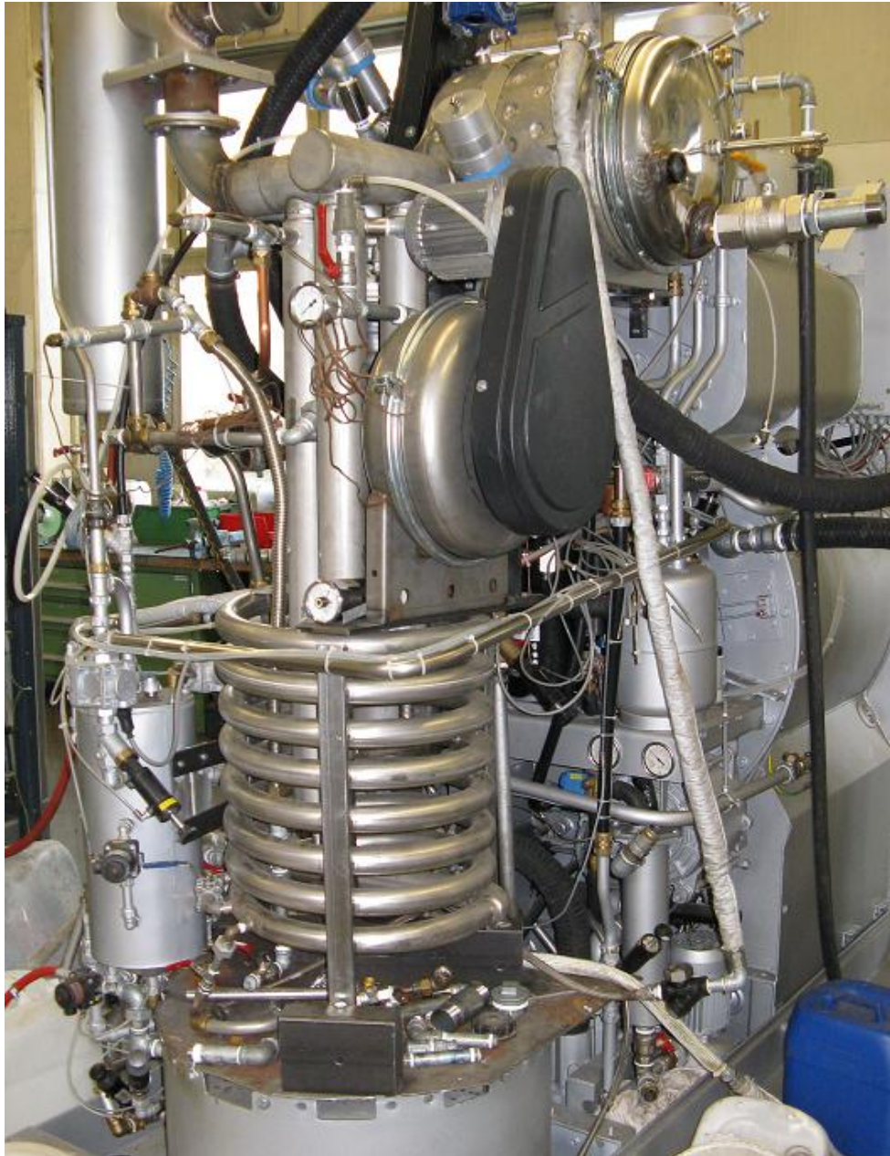
Abbildung 6: Einbau der neuen Destillation in eine BÖWE Reinigungsmaschine Typ P18
