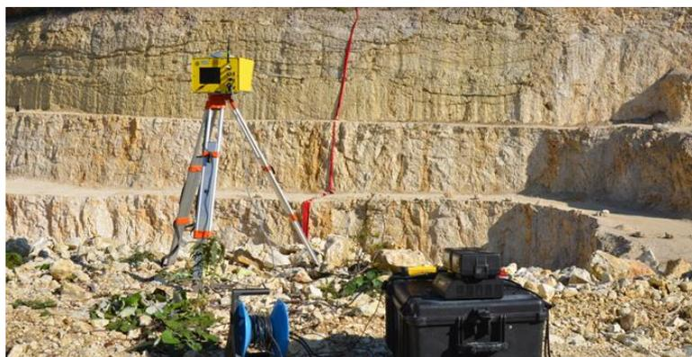
Abb. 3.10: Optech-ILRIS 3D-Scanner bei der Aufnahme der Ostwand des Pumpspeichers Blautal
