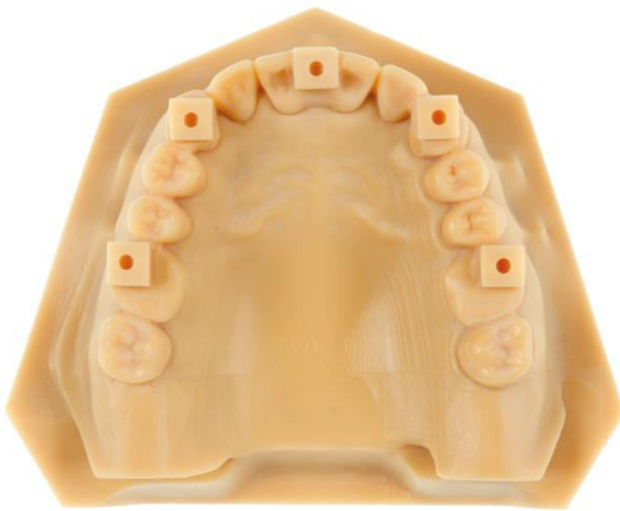
Abbildung 1: Mastermodell aus FotoDent-LED®-Harz mit fünf Referenzzylindern als Messpunkten
