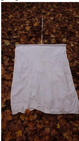
Abbildung 16: Aufbau einer Zeckenfahne. Eine Zeckenfahne besteht aus einem Rundholz (Griff), einem 1m langen Kantholz (Verbindung) und einem 1m x 1m großen Moltontuch (Fahne).
