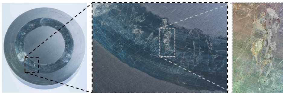
Abbildung 4: Lagerschaden an einer Axialgleitlagerprobe
