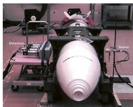
Abbildung 9: Aktive Neutronenmessungen mit Szintillatoren an einem Sprengkopf 59
