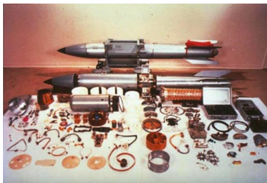
Abbildung 4: B-61 zerlegt in die einzelnen Komponenten 38
