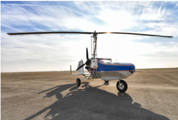
BILD 1. Tragschrauber Versuchsträger, modifiziert auf der Basis eines AutoGyro MTOfree
