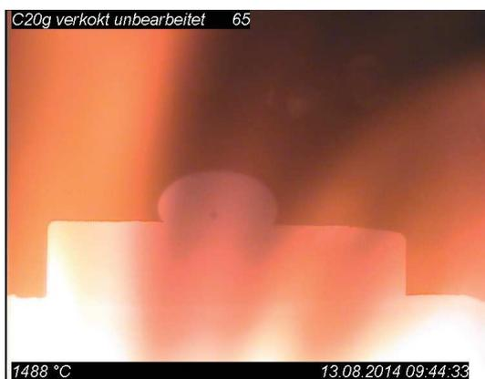
(c) Probe mit vollständig aufgeschmolzenen Stahltropfen.
