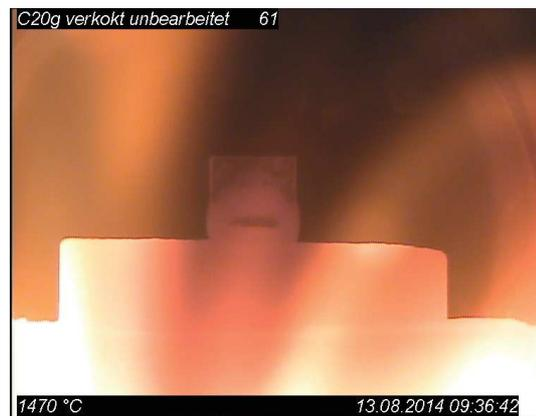
(b) Probe bei beginnender Erweichung der Stahlprobe
