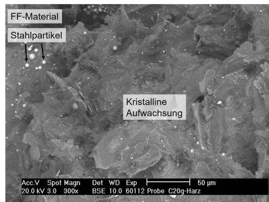
(b) Kristalline Aufwachsungen und Stahlpartikel auf harzgebundener Referenzprobe (300fache Vergrößerung).
