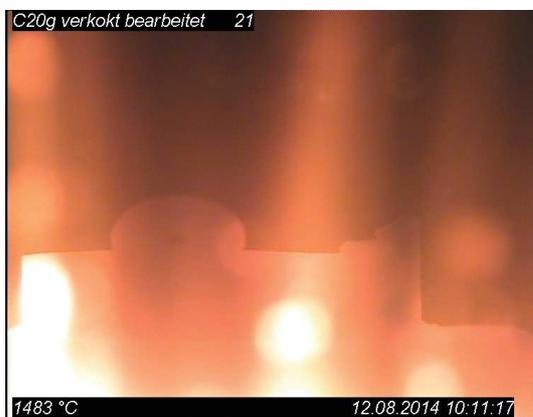
(c) Probe mit vollständig aufgeschmolzenen Stahltropfen.
