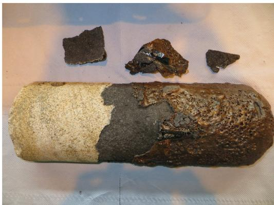
(e) Stopfenaußenseite von 4C-TiO<sub>2</sub>-Fru mit abgelöster Schlacke.
