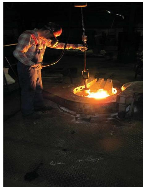
Abb. 5.29.: Durchführung des Eintauchversuches in der Stahlgießerei (aus [Roun17]).
