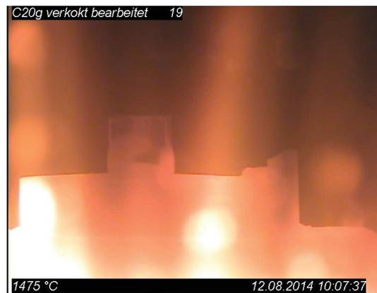
(b) Probe bei beginnender Erweichung der Stahlprobe
