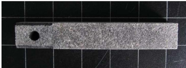
Abb. 5.22.: Stabprobe für den dynamischen Fingertest.
