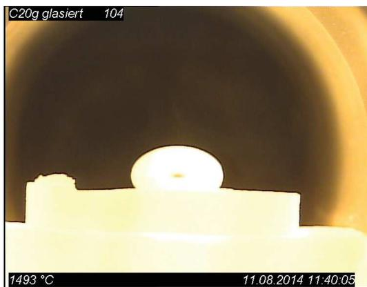
(c) Probe mit vollständig aufgeschmolzenen Stahltropfen.
