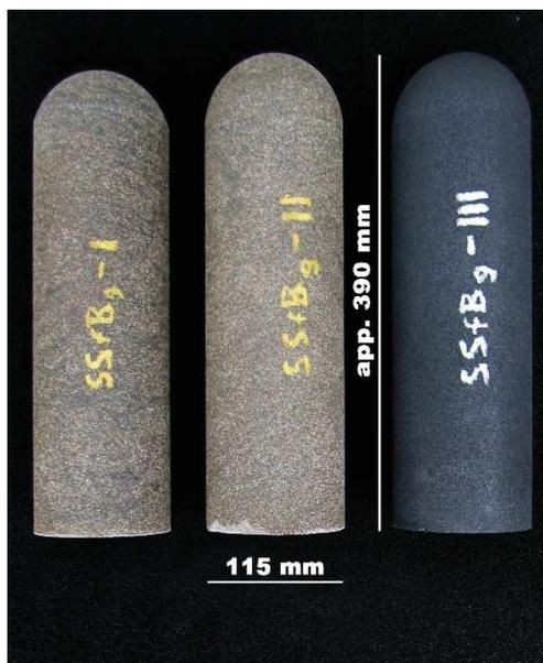
Abb. 5.28.: Abgedrehte und selbstglasierte bzw. verkockte Monoblockstopfen für den Tauchversuch bei der Fa. Geweke (aus [Roun17]).
