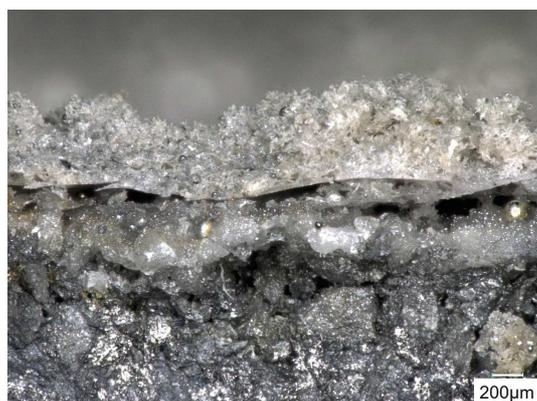
**(a)** Fructosehaltige Probe mit  $TiO_2$  nach dem Stahltest (100fache Vergrößerung).
