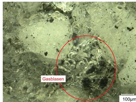
Abb. 5.9.: Mikroskopische Aufnahme der glasigen Selbstglasur (Vergrößerung: 300fach).
