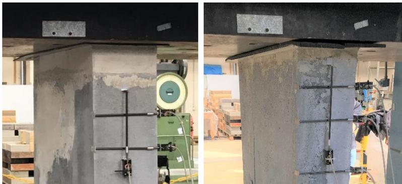
*Bild 4-5: Lasteinleitungsbereich der VR2 (Normalbetonschicht/ Gummilage; links) und VR3 (Mörtelbett/ Blech/ Gummilage; rechts) [21]*
