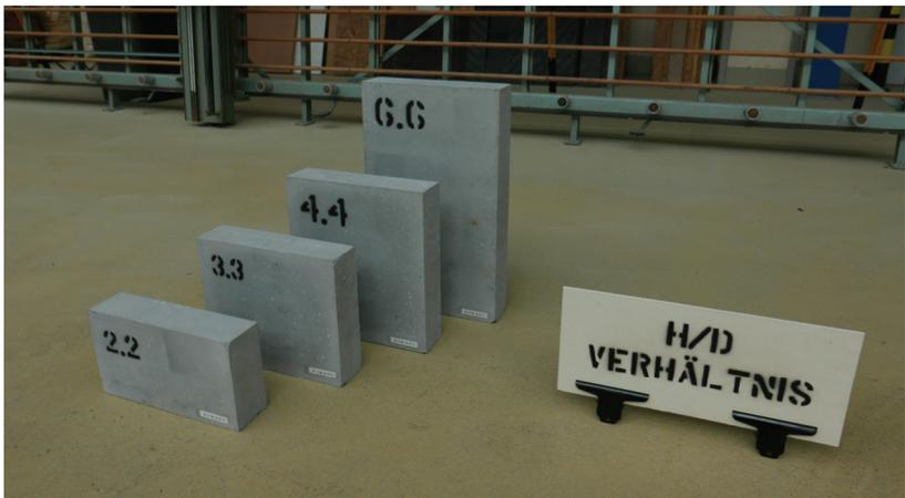
Bild 4-17: Prüfkörper der VR3 mit h/d = 2,2 bis 6,6 [89]
