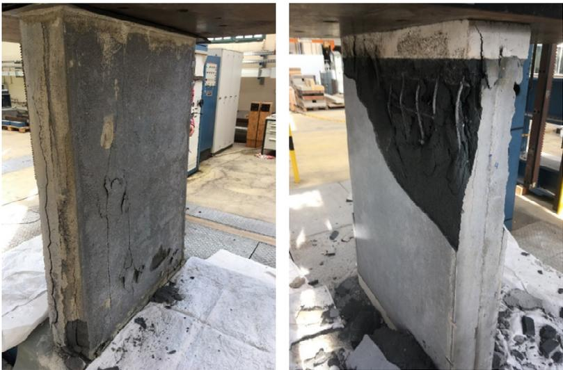
*Bild 4-8: Exemplarische Versagensbilder unbewehrter (links: VR3.1) und bewehrter Wandbauteile (rechts: VR2.1) [21]*
