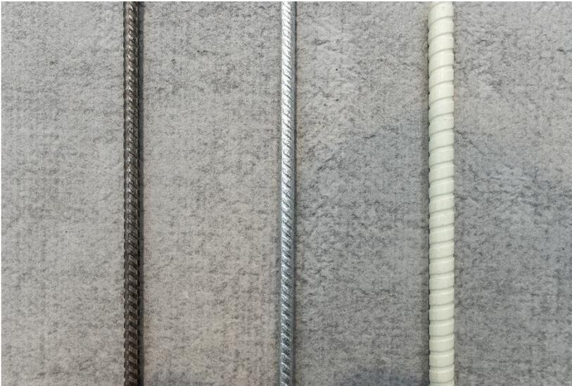
*Bild 5-1: Unterschiedliche Bewehrungsarten (v.l.: Betonstahl, verzinkter Betonstahl, GFK-Bewehrung; Foto: Jan-Oliver Kunze)*
