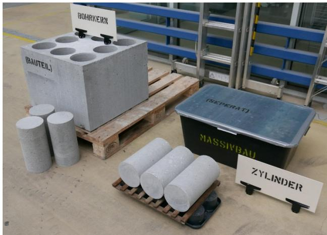
*Bild 4-25: Bohrkerne und Zylinder zur Untersuchung des Druckfestigkeitsverhältnisses Bauteil/Probekörper [89]*
