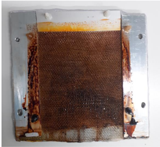
Abbildung 32: Verstopfung von Aerosolabscheidegitter und Durchbruch des Aerosols (rechts: Mit Verjüngung zur Kreislaufführung des Luftstroms).
