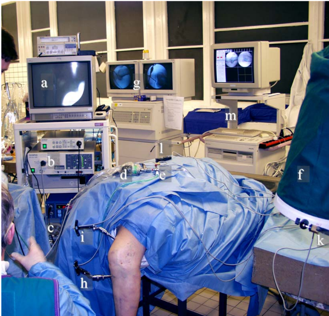
Abbildung 11: Übersicht der Instrumente beim Präparateversuch. Arthroskopie mit Monitor (a), Kaltlichtquelle (b), Rollenpumpe (c), CCD-Kamera (d), Portal mit Wasserzulauf und -ablauf (e). Durchleuchtung mit C-Bogen-Detektor (f) und Monitor (g). Navigation mit tibialer (h) und femoraler (i) sowie C-Bogen-Tracker (k), Kalibrierphantom (l) und Konsole (m), Verfolgungskamera nicht abgebildet, in der Blickachse der Fotokamera platziert.
