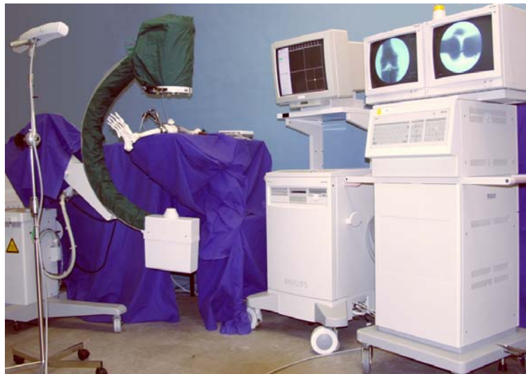
Abbildung 6: Versuch zur Praktikabilität am Kunststoffskelett. Von links nach rechts: Optisches Positionsmesssystem, C-Bogen, Kunststoffmodell einer unteren Extremität mit fixierten Trackern, XGuide-Navigationsmonitor, C-Bogen-Monitor.
