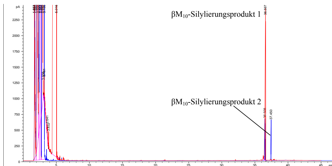
Abbildung 4.35: Gaschromatogramm von \beta M_{10} blau: nach Silylierung mit BSTFA/MSTFA, rot: nach Silylierung mit TMSI/MSTFA in Pyridin
